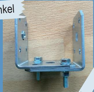
Hier wird das Brett später reingestellt. An die beiden Winkelpaare schraubt Ihr nun jeweils einen dritten Winkel an, im Abstand der Dicke des Feuerschalensandes. Den Abstand erreicht Ihr durch das Einlegen von Muttern. Auf der Oberseite des Brettes wird ein Haken eingeschraubt, an dem das Brett abgespannt wird.
